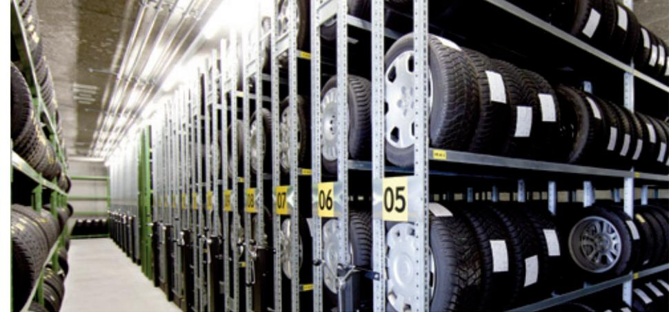
4500 Reifen finden im Pneuhotel der Garage Marti Platz. Wie bei einem richtigen Hotel, gibt es eine Art «Reception». Dort checkt mittels eines Datenblattes jeder Reifen ein, indem seine Profiltiefe eingetragen wird. Danach wird er in einer Waschmaschine gereinigt, bevor er in seinem Regal übersommt respektive überwintert. In der Halle selber herrschen ideale Temperaturen, damit der Gummi keinen Schaden nimmt.
